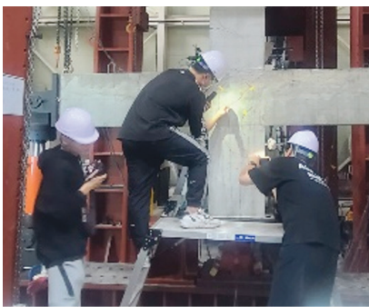
그림 9. 골조식 구조 접합부에 대한 실험연구
