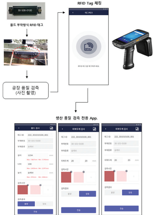
그림 5. RFID 기반 생산 품질 검측 시스템
