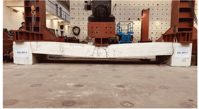
그림 4. 하이브리드 PC 벽체 부재의 면외 구조성능 실험
